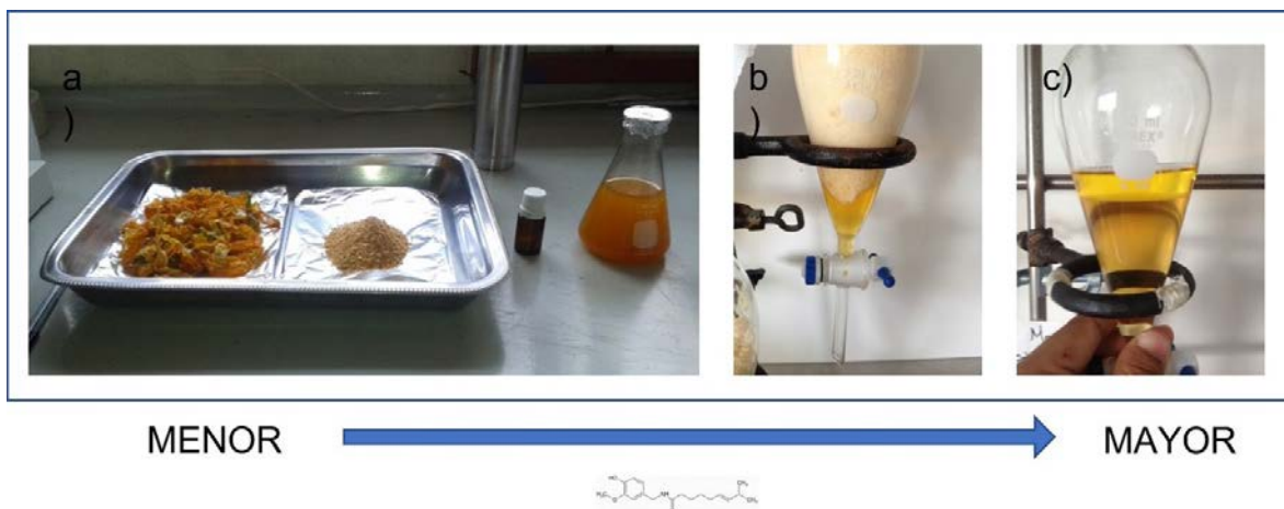
Figura 3. Extractos de capsaicinoides: a) extracto con aceite; b) saponificación del extracto; c) extracción líquido-líquido de la fracción no saponificada
