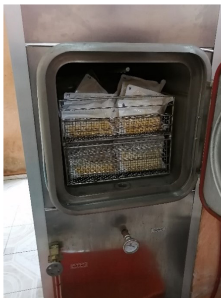
Figura 3. Autoclave con bolsas de cochinita pibil después de esterilizar Fuente: Fotografía proporcionada por Alfonso Álvarez Sánchez (2026)
